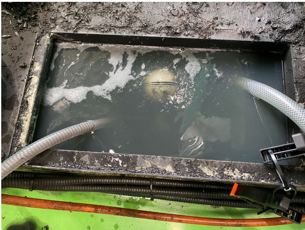
400 L 30分経過後。 素材FCD 黒い液が清澄化しタンクの底が見えるようになりました。
