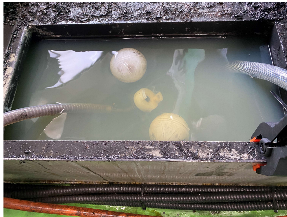
400 L 30分経過後。 素材FCD 黒い液が清澄化しタンクの底が見えるようになりました。
